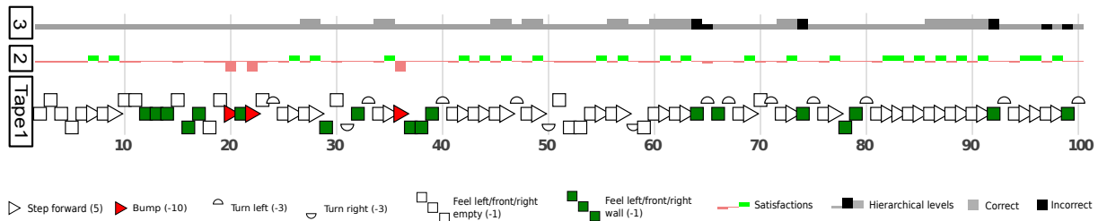
Figure 5 : 100 premières expériences énoncées par le robot. Bande 1 : expériences primitives énoncées au cours du temps : avancer (triangle blanc), collision (triangle rouge), tourner (demi-cercles), sentir vide (carré blanc), sentir mur (carré vert). Les positions des carrés haut/milieu/bas représentent les directions gauche/devant/droite. Bande 2 : valence des expériences énoncées représentée en bar-graphe (vert positive, rouge négative). Bande 3 : Niveau hiérarchique des expériences intentionnellement énoncées (gris : énonciation primitive réussie ; noir : énonciation primitive échouée, interrompant l'énonciation de l'expérience abstraite). L'expérience abstraite sentir_vide_devant – avancer est énoncée pour la première fois aux pas 27-28. Aux pas 64, 74 et 92, cette expérience abstraite a été interrompue (segment noir de second niveau en bande 3) en raison du fait que l'expérience primitive tentée sentir_vide_devant a résulté en l'expérience sentir_mur_devant , ce qui dissuada le robot d'aller vers le mur et le fera plutôt tourner à gauche.
